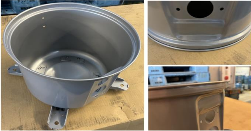
絞り成形品の縁曲げ成形の製品例。
