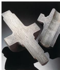
冷間鍛造加工による鍛流線(ファイバーフロー)の例。
