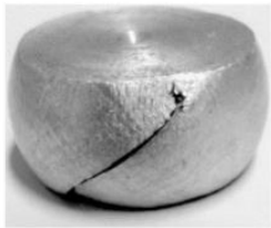
斜め割れの現象写真
