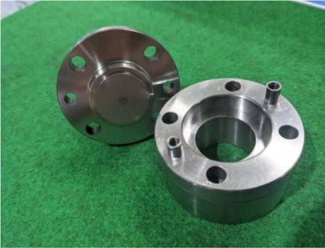
せん断加工の中で基本的な加工である打抜き加工に使用される、打抜き金型についてご説明します。
